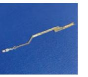
精密回路付き薄膜金属ベース基板
