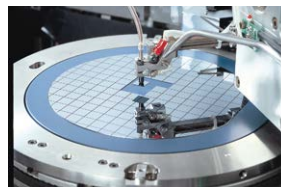
薄膜チップをダメージレスでピックアップできるダイシングテープ
