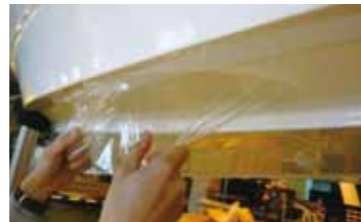
「マリングライド™」は透明な粘着フィルム。簡単に船底に貼ることができます。
