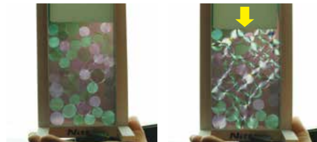
実験キット 粒状物質にかかる圧力の分散の様子
